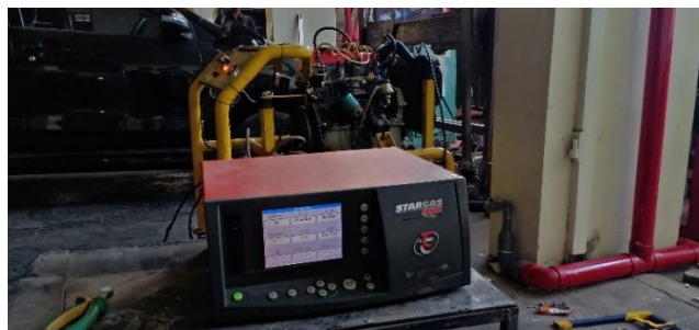
Gambar 14. Proses pengujian gas buang
