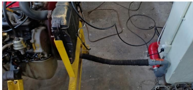
Gambar 13. Menguji gas buang sekitar engine stand setelah menggunakan sistem instalasi gas buang
