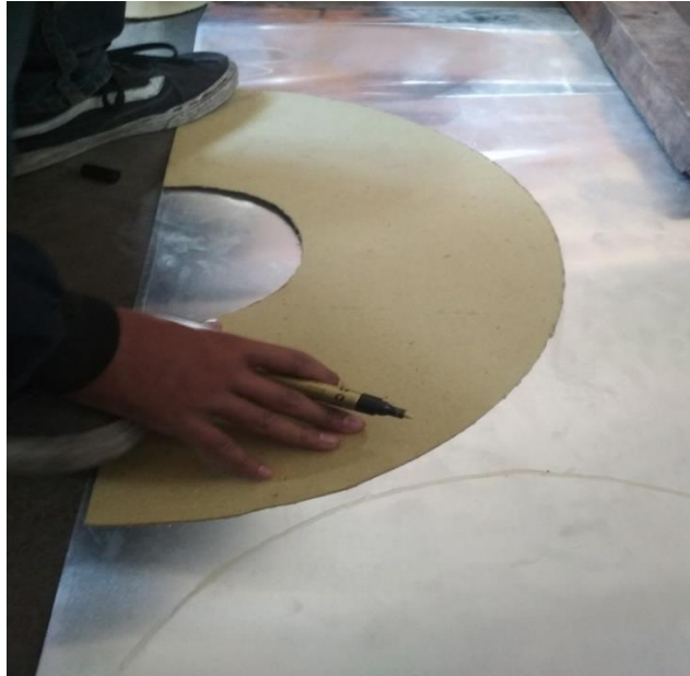
Gambar 4. Pembuatan mal pada plat
