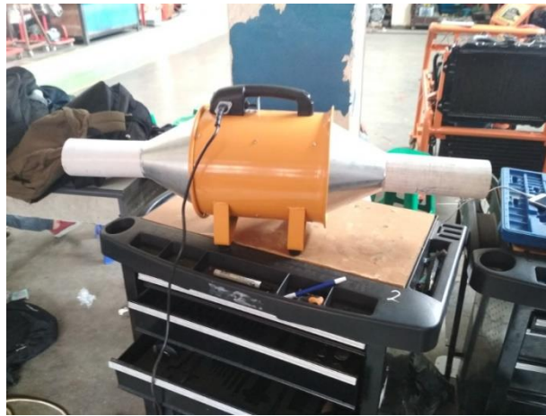
Gambar 6. Hasil pemasangan Corong dengan Exhaust Blower
