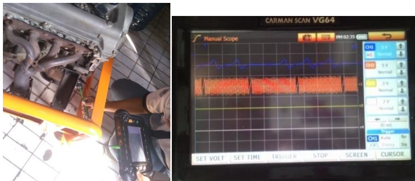
Pengujian Gelombang Listrik Pada Crankshaft Position Sensor dan Camshaft Position Sensor
