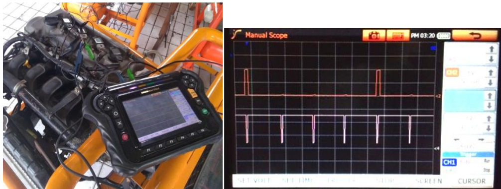
Pengujian Gelombang Listrik Igniter Pada Terminal IGT dan IGF
