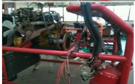
Gambar 50. Melepas Kabel Engine yang Lama
