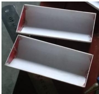
Gambar 1. Pembuatan box/rumah kisi-kisi udara AC
