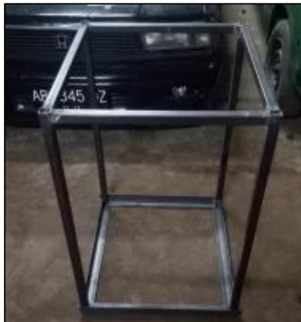
Gambar 6. Pengelasan rangka bagian atas dan bawah caddy tools .
