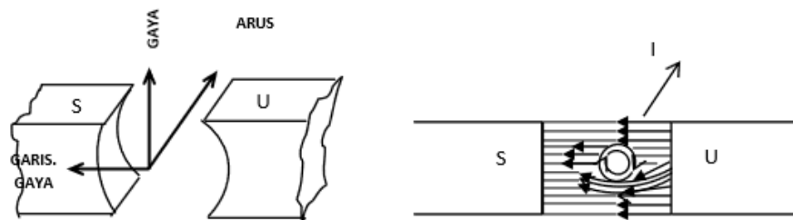
Gambar 10. Medan Magnet Pada Motor DC
