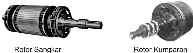
Gambar 11. Rotor sangkar dan rotor kumparan
