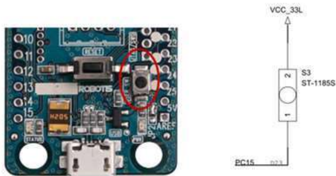
Gambar 33. Rangkaian Internal pada User Button (Sumber: ROBOTIS)
