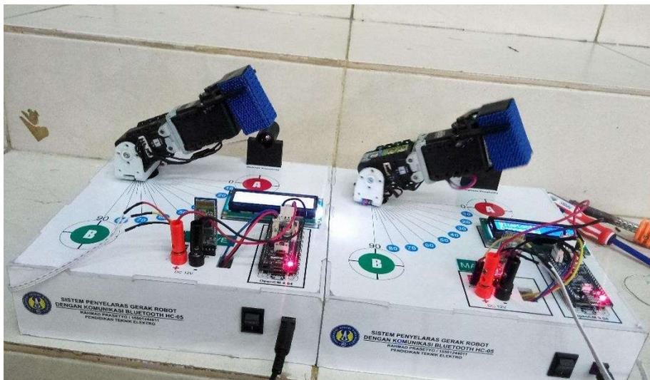
Gambar 22. Hasil Perancangan Modul Praktik Penyelaras Gerak Robot
