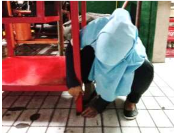
Gambar 35. Memasang Karet Kaki Meja Kerja Overhaul
