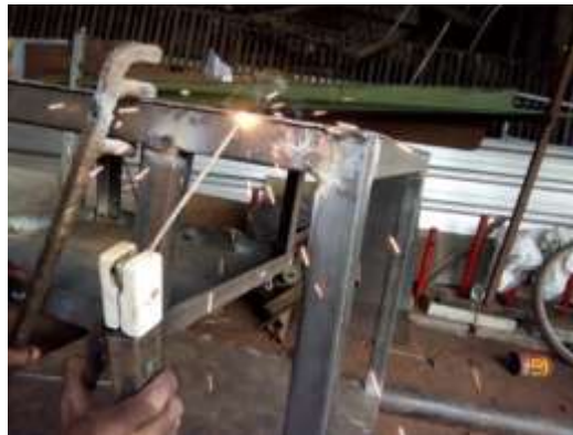
Gambar 29. Pengelasan Plat Atas pada Meja Kerja Overhaul
