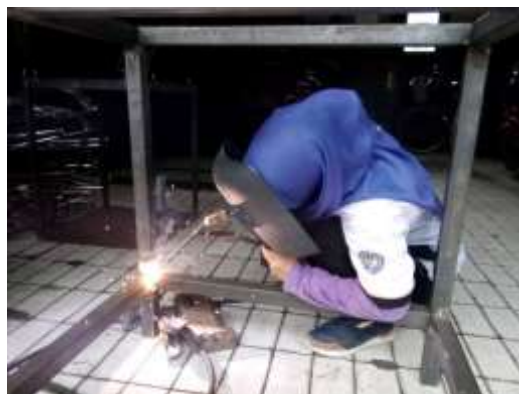
Gambar 26. Pengelasan Rangka Meja Kerja Overhaul
