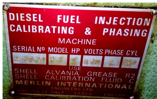
Gambar 28. Spesifikasi Test Bench yang ada di Jurusan
