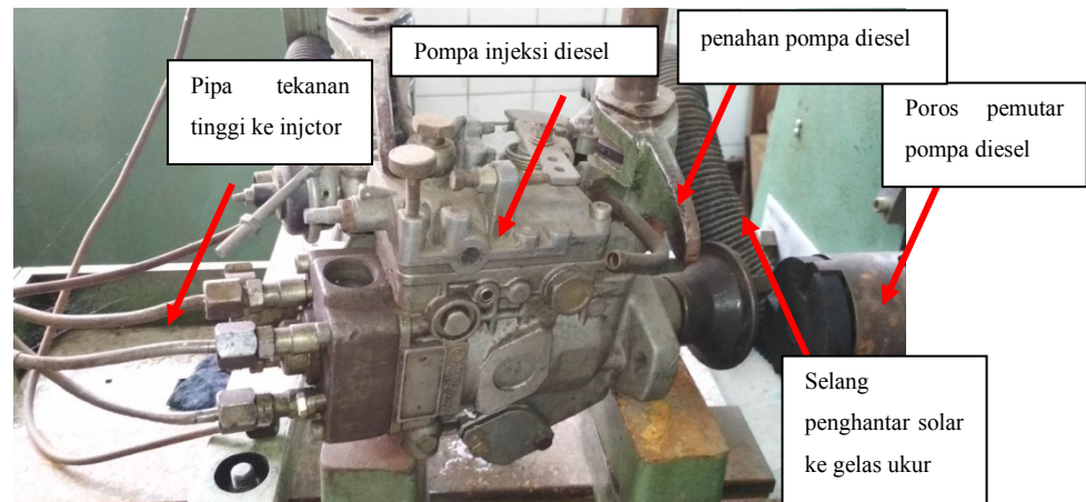
Gambar 7. Pompa injeksi diesel terhubung ke test bench
