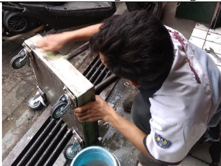
Gambar 48. Pendempulan dan Pengamplasan
