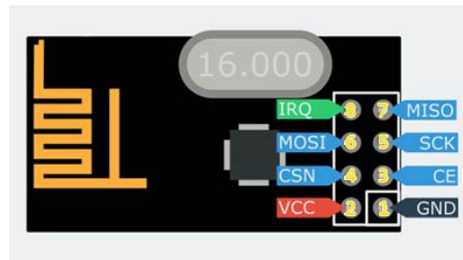
Gambar 81. Konfigurasi Pin nRF24L01
