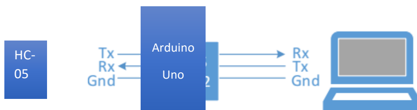
Gambar 1. Komunikasi Serial Mikrokontroller dengan Laptop melalui Bluetooth HC-05
