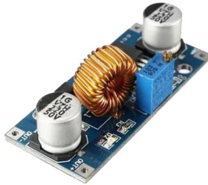
Gambar 13. Catu daya switching ( Sumber : Dokumentasi Pribadi )
