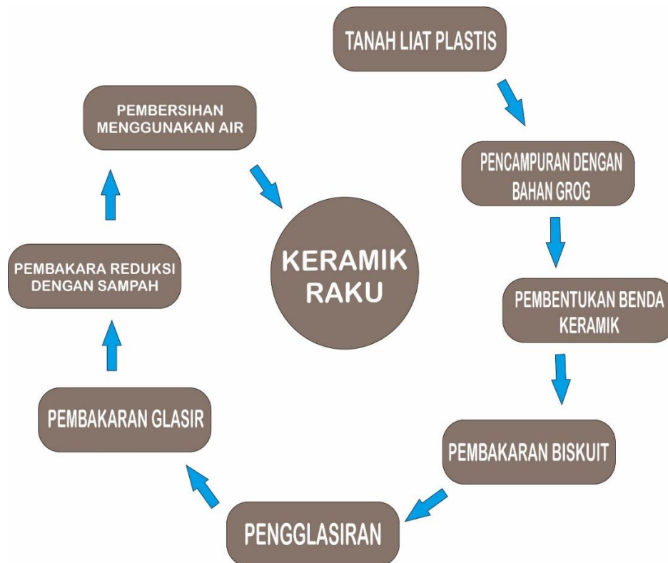
Gambar 4. Skema proses pembuatan keramik Raku. Sumber: (Dany: 2019)
