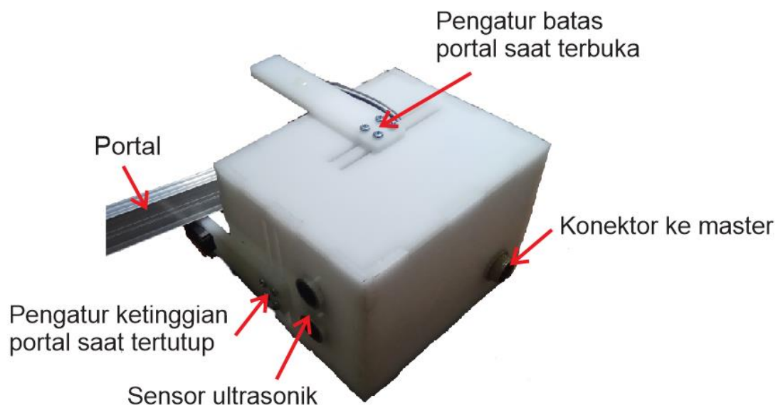
Gambar 20. Bentuk fisik bagian portal dengan keterangan
