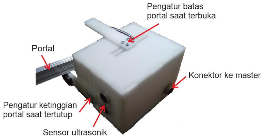
Gambar 2. Bentuk fisik bagian portal dengan keterangan
