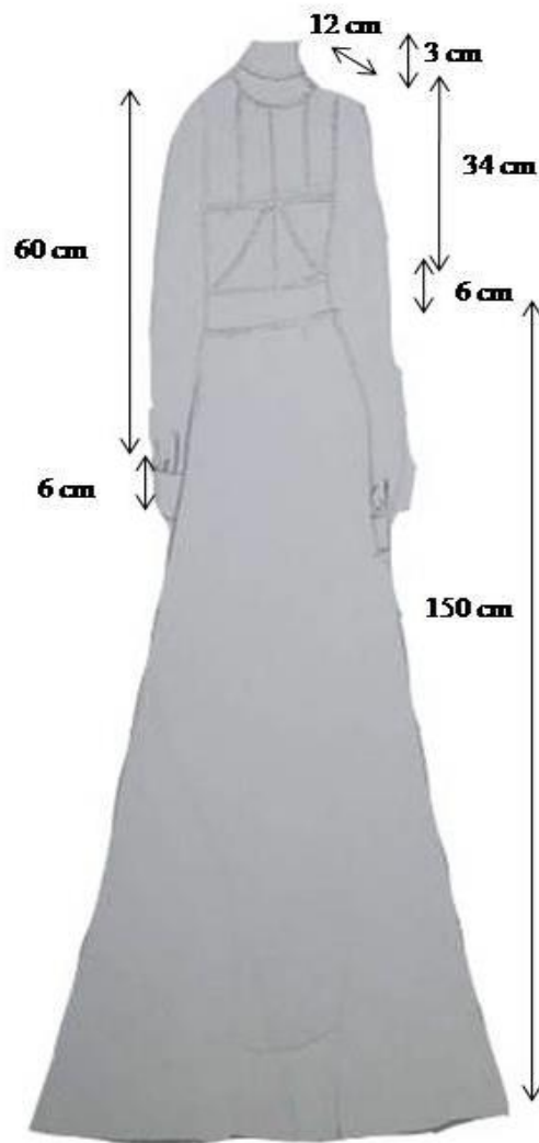
Gambar 8. Gambar Kerja Tampak Belakang
