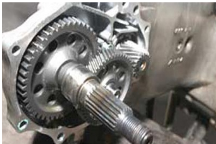
Gambar 16. Konstruksi gigi reduksi CVT (Arianto, 2011)
