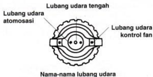
Gambar 7. Nama lubang pada air cap (Team B&P, 1997: 4-5)
