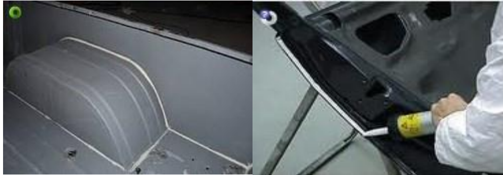
Gambar 23. Sealer diaplikasikan pada bagian dalam panel kabin kendaraan dan sealer diaplikasikan pada bagian dalam panel pintu (Argana, 2013: 78)
