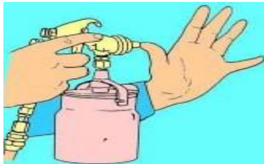
Gambar 15. Perkiraan jarak penggunaan spraygun menggunakan 1 jengkal tangan (Argana, 2013: 126)
