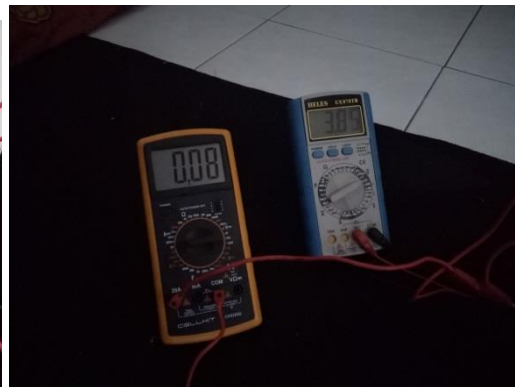
Lampiran 6. Pembacaan arus dan tegangan saat proses pengosongan ( discharging ) modul superkapasitor 80F/16.2V dan kelipatannya
