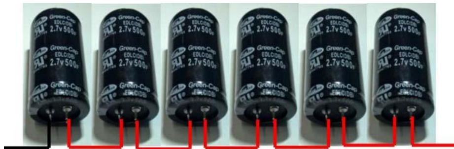
Gambar 20. Rangkaian seri 6 buah superkapasitor 500F/2.7 volt (80F/16.2V)
