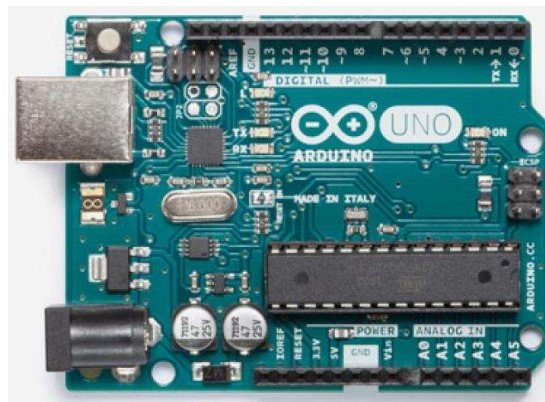
Gambar 2. Bentuk Fisik ArduinoUno R3 Sumber: ( https://store.arduino.cc/usa/arduino-uno-rev3 )
