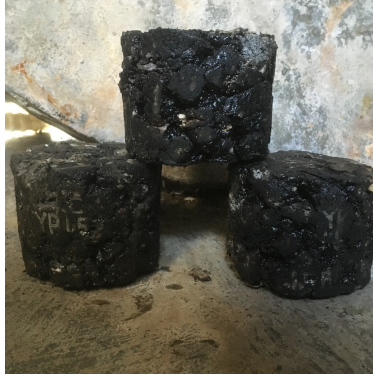
Gambar 41. Hasil Benda Uji Polymer 0,5%
