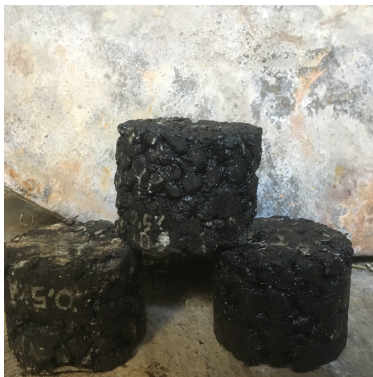
Gambar 43. Hasil Benda Uji Polymer 1,5%
