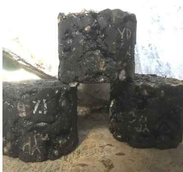
Gambar 42. Hasil Benda Uji Polymer 1%
