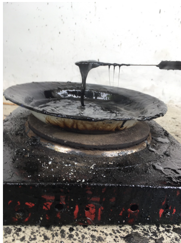
Gambar 45. Aspal dengan Campuran Plastik
