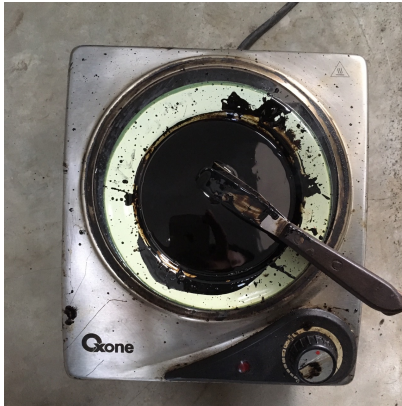
Gambar 44. Proses Pemanasan Aspal
