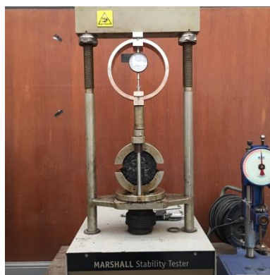
Gambar 58. Penekanan Benda Uji dengan Marshall Test Machine
