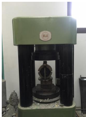
Gambar 60. Penekanan Benda Uji dengan Mesin Tekan Beton
