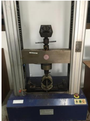
Gambar 59. Penekanan Benda Uji dengan UTM
