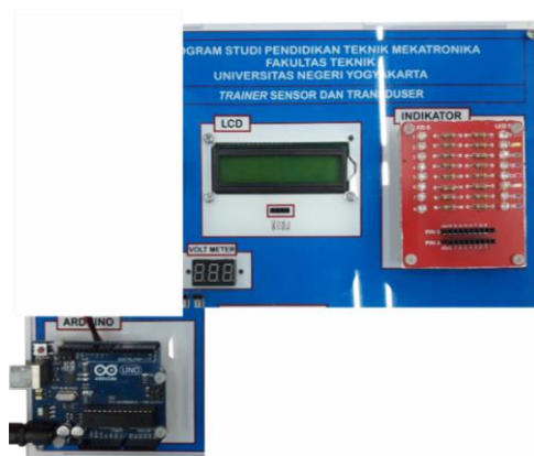
Gambar 33. Controller dan Penampil Data
