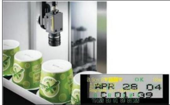
Gambar 2. Pemeriksaan label berbasis computer vision
