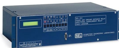
Gambar 3. Relai Jarak (Sumber: Selinc.com)
