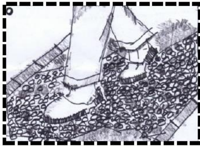
Gambar 9. Lantai Dasar Berstruktur dari Pasangan Kerikil, dapat Membantu Arah Gerak atau Mobilitas Tunanetra (Sumber: Hamka, 2017)
