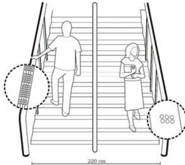
Gambar 12. Tangga yang Dilengkapi dengan Huruf Braille di Sisi Atas Pegangan Rambatan pada Interval Tertentu yang Menunjukkan Posisi Anak Tangga (Sumber: Peraturan Menteri PUPR No. 14/PRT/M/2017)
