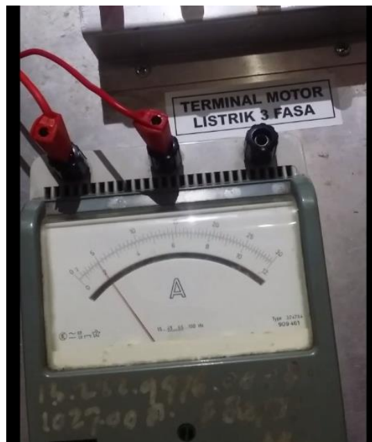
Gambar 14. Pengujian Pembebanan Motor Saat Beroperasi
