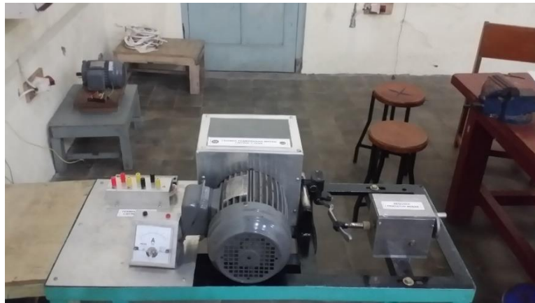
Gambar 10. Trainer Beban Motor Listrik Setelah Perakitan
