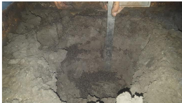
Proses pengambilan sampel kadar air pada kedalaman 10 cm dan 20 cm
