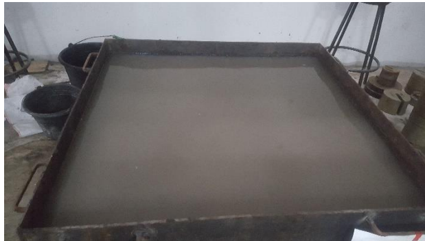
Perendaman air selama 24 jam untuk membuat tanah menjadi jenuh air
