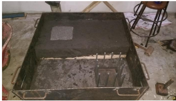
pembuatan model drainase layer pasir horizontal
