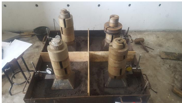
Proses pembebanan tanah selama 24 jam
