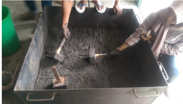
Proses memasukkan tanah ke dalam boks uji
