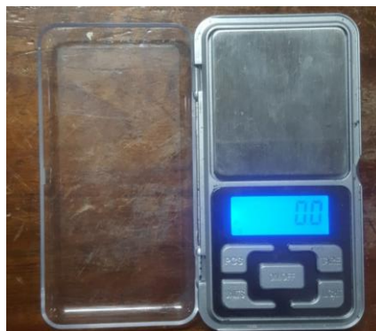
Gambar 24. Timbangan dengan ketelitian 0,01 gr
