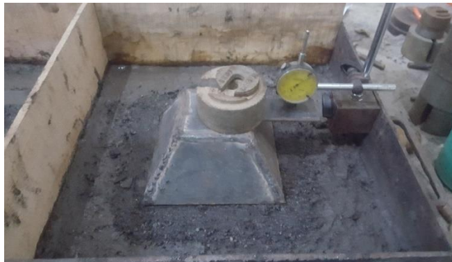
Gambar 17. Fungsi besi pemodelan embankment sebagai tumpuan beban dan dial gauge
