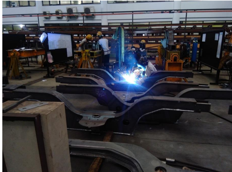
Gambar 20. Proses Pengerjaan Part Bogie
