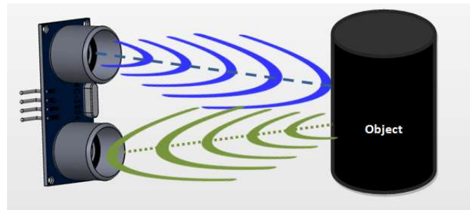
Gambar 6. Prinsip Kerja HC-SR04
