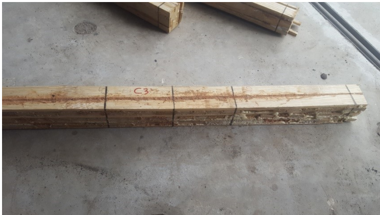
Gambar kerusakan benda uji STL
