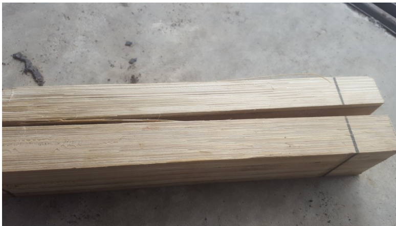
Gambar kerusakan benda uji SSL
