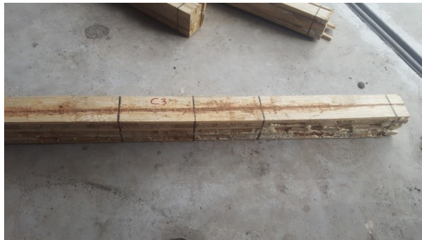
Gambar 17. Kerusakan benda uji STL
