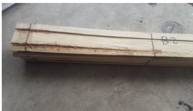
Gambar 16. Kerusakan benda uji SBL
