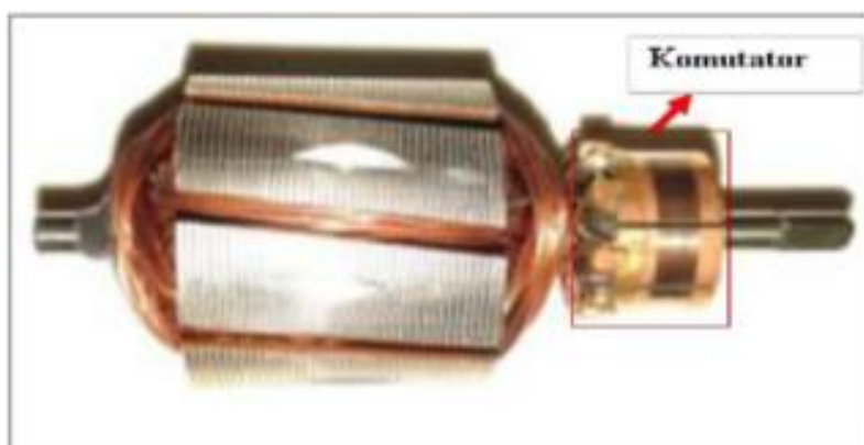
Gambar 6. Komutator Sumber: Tri Hadi Susanto 2011
