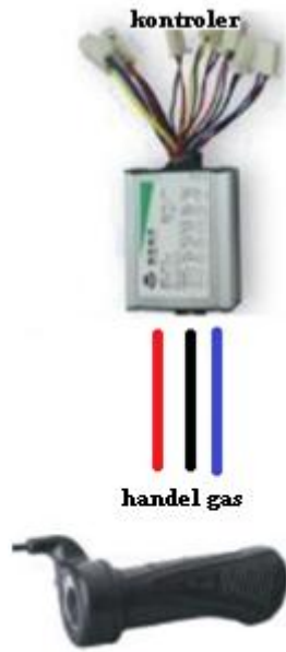
Gambar 6 penyolderan kontroler dengan handel gas
