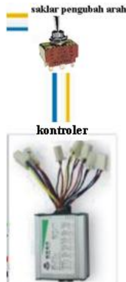
Gambar 4 penyolderan saklar pembalik arah dengan kontroler
