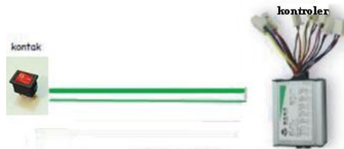
Gambar 5 penyolderan kontroler dengan saklar on/off
