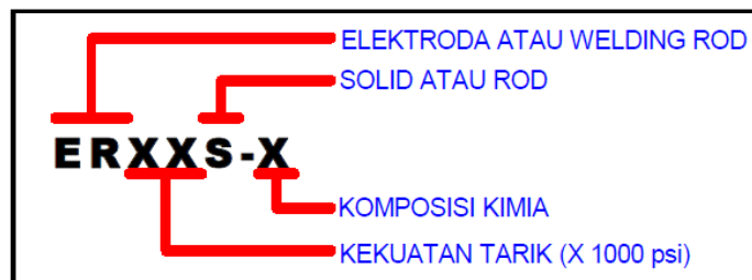
Gambar 8. Model penomoran elektroda ferro menurut AWS
