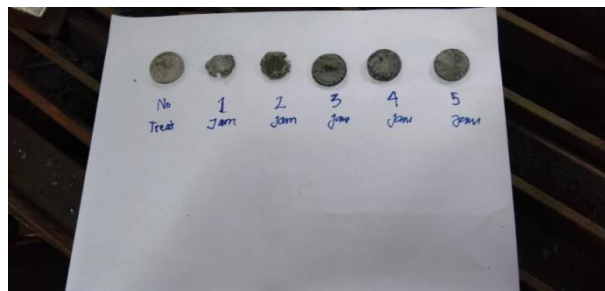
Gambar 10. Benda Kerja Hasil Proses Electroless Setelah Dipanaskan Suhu 800°C.
