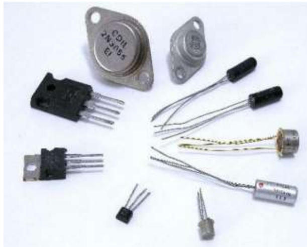
Gambar 15 Bangun fisik dan konstruksi transistor bipolar
