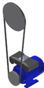
Gambar 1. Sistem Transmisi Pada Knife Grinding Machine
