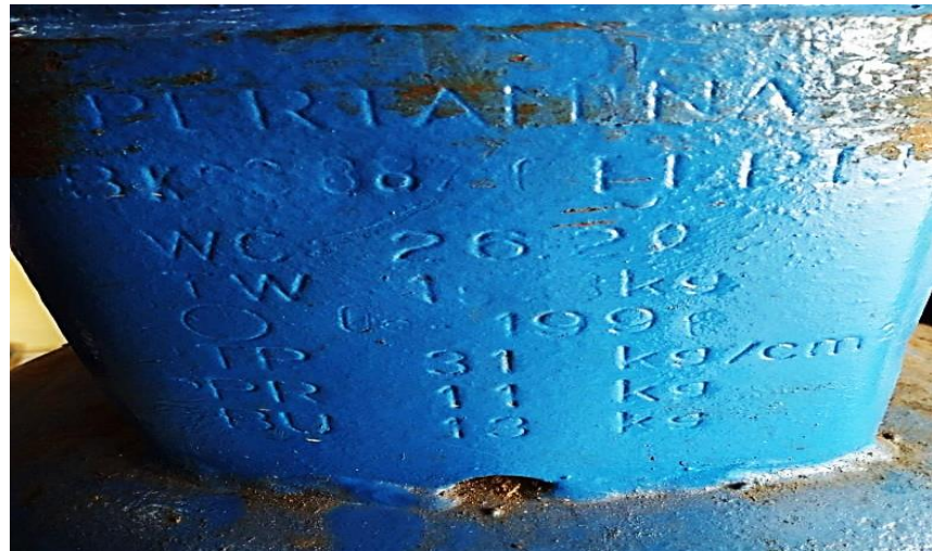
Gambar 5. Spesifikasi Tabung Gas LPG
