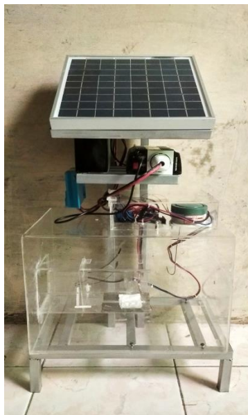
Gambar 26. Hasil realisasi perangkap tikus otomatis
