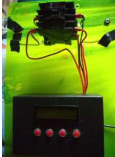
Gambar 13. Pengaman Beban Lebih Berbasis Arduino Nano
