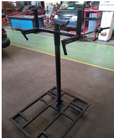
Gambar 27. Alat SST Melepas dan Memasang Roda Kendaraan
