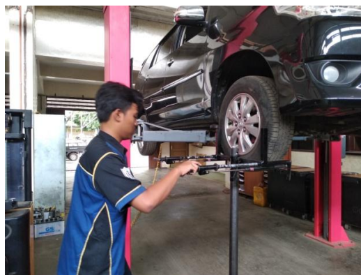
Gambar 38. Melepas Pengancing Roda pada Alat
