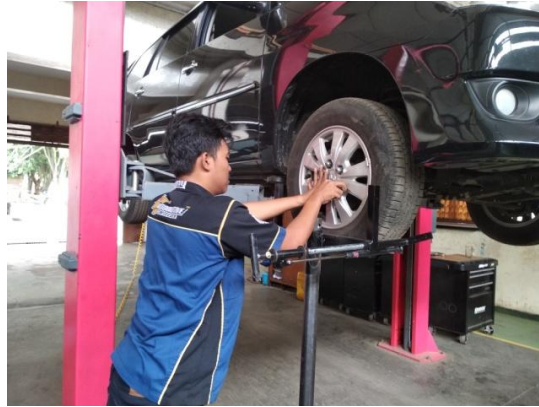
Gambar 39. Memasang Baut Roda Kendaraan
