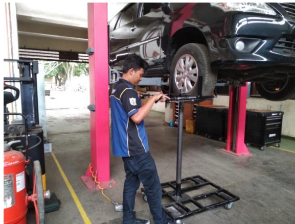
Gambar 40. Melepas Pengancing Roda Trolley pada Alat
