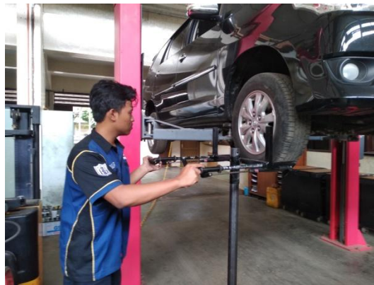
Gambar 32. Memposisikan Alat pada Roda Kendaraan
