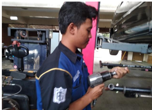
Gambar 35. Melepas Mur Roda Kendaraan dengan Impack
