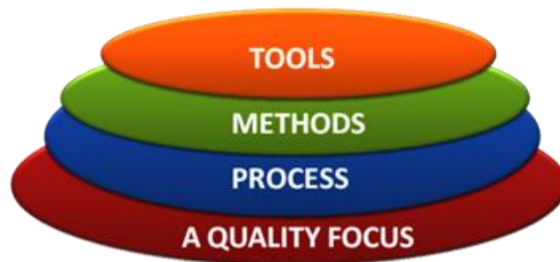
Gambar 1. Lapisan-lapisan rekayasa perangkat lunak (Pressman, 2012:16)
