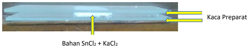
Gambar 3.1. Bahan \text{SnCl}_2 + \text{KCl} yang telah dihimpit oleh dua buah preparat.
