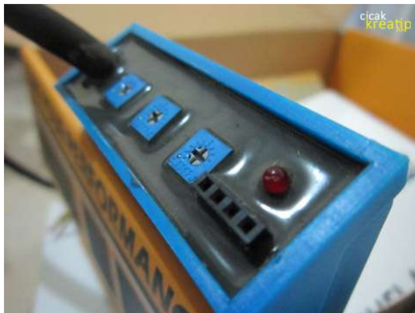
Gambar 22. Selektor setelan Pada Piggyback Iquiteche
