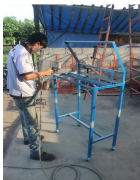
Gambar 29. Finishing Pengecatan Rangka (Anonim,tt)
